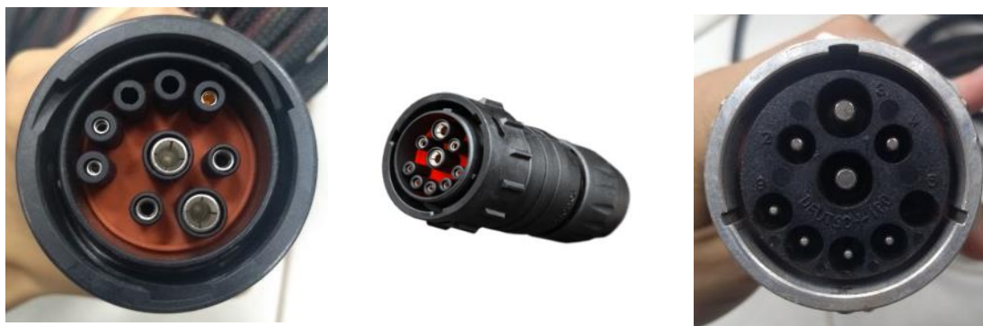
Fig. 6.29: A conexão ISOBUS facilita a automação de operações agrícolas, aumenta a eficiência e a precisão das tarefas e permite o uso de softwares e sistemas de gerenciamento de dados agrícolas mais avançados.
