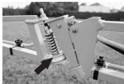
Fig. 10.12: Articulações da barra de pulverização lateral
