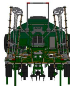
Fig. 6.20: barras de pulverização recolhidas e pés de apoio estendidos.
