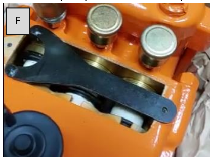
Fig. 8.7: Modo de disposição da chave para fechar o compartimento com a placa de instruções.
