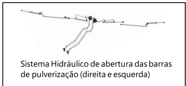
Fig. 8.1: Representação do sistema hidráulico e componentes.
