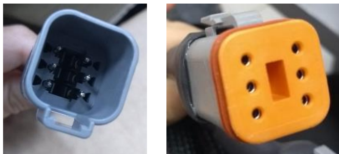
Fig.6.27: Conexões quadradas de 6 vias: macho (à esq.) e fêmea (à dir.).
